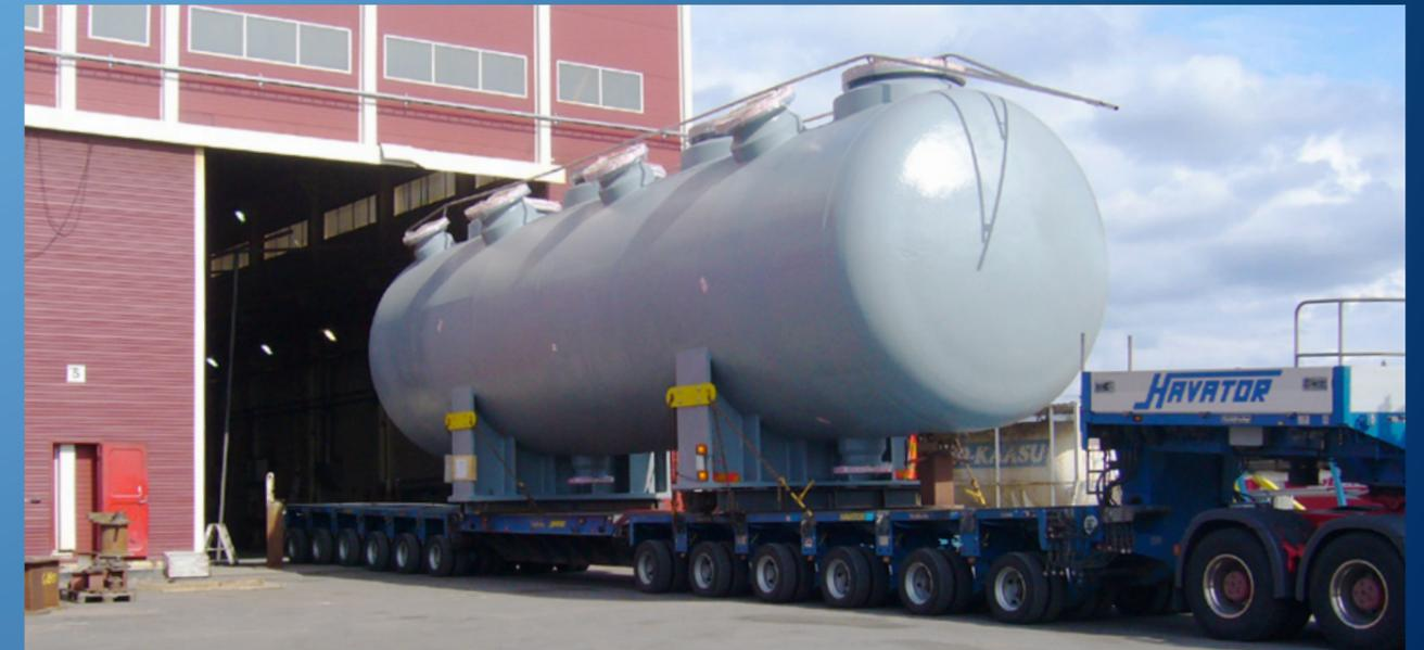
Im Werk säurefest ausgemauerter Autoklav-Behälter
