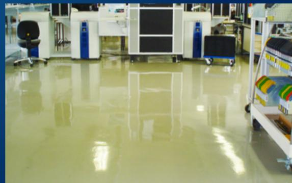
ESD-Bodenbeschichtung für die Produktion von elektronischen Bauelementen
